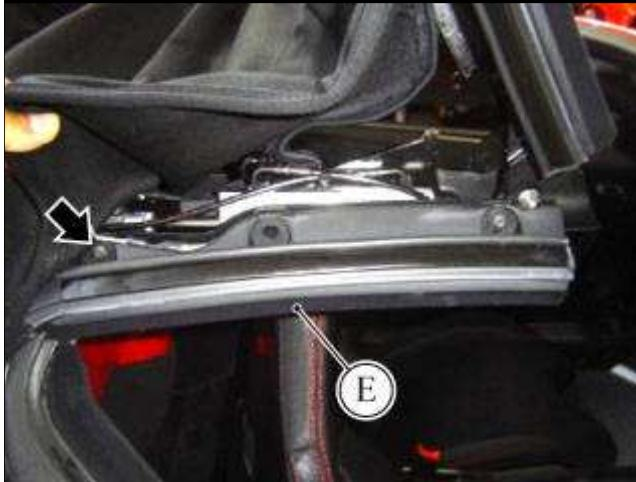
● 如果密封件未正确连接, 松开指示的紧固后部车顶的后部螺钉, 并调节后部车顶密封件 (**E**), 直到它与侧面密封件正确连接。
