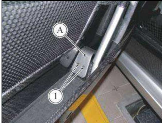
● 拆卸紧固把手 (A) 的两个螺钉 (1)。
