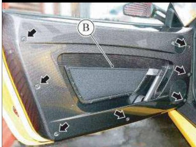
● 拆卸紧固车门饰板 (B) 的七个螺钉。
