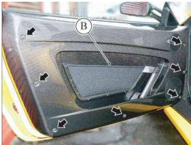
将面板 (B) 安装到车门框架上并通过拧紧指示的七个螺钉紧固。
