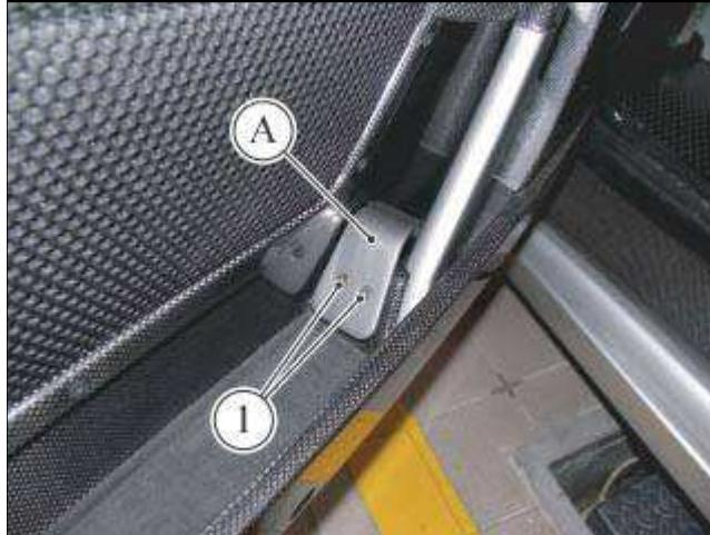
定位好内侧打开把手 (A) 并用两个螺钉 (1) 将其紧固。
