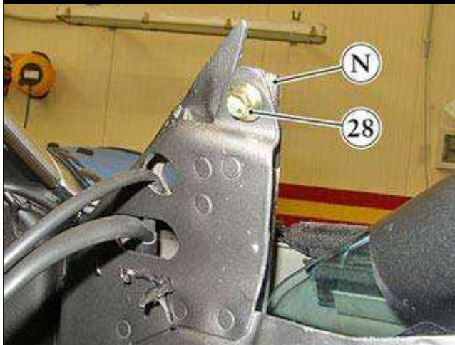
● 要拆卸前部导向装置(N)上端, 拧下紧固螺钉(28)。
