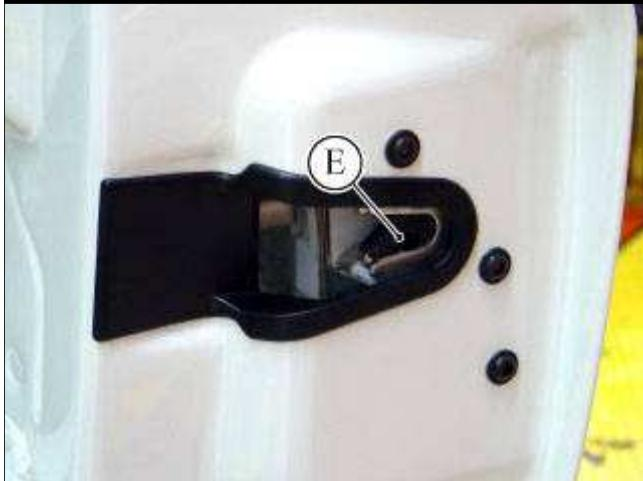
● 打开车门，用合适的螺丝刀，卡住锁 (E)。
