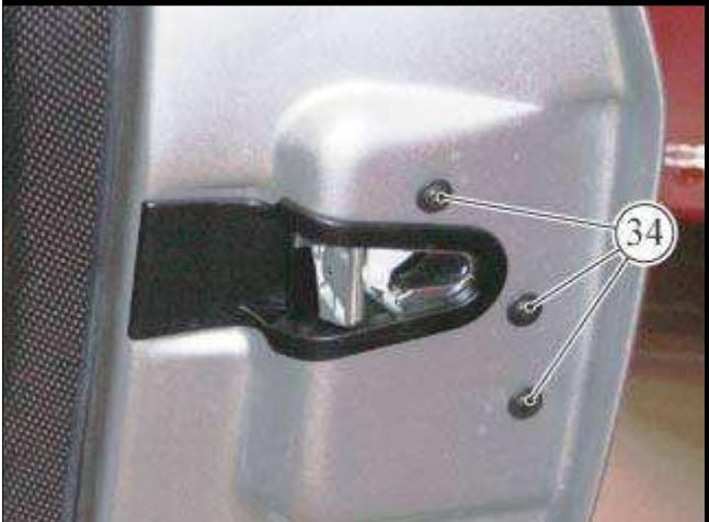
● 拆卸装饰固定板并松开外部紧固螺钉(34)。
