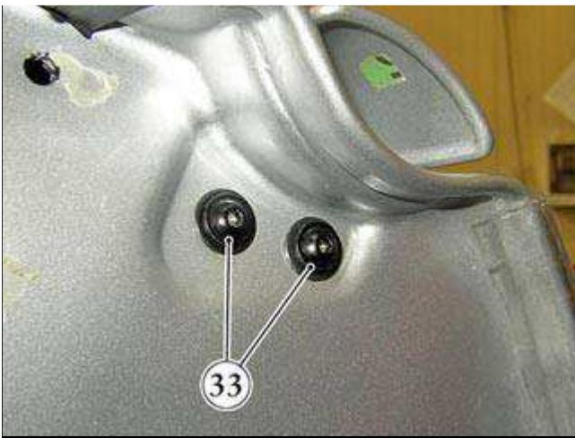
● 拧下将手柄紧固到车门框的两个外部螺钉(33)。
