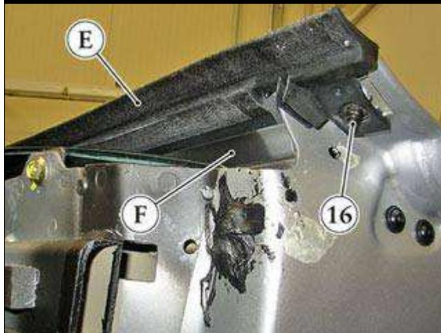
● 当重新安装时，对齐外部车窗刮刀密封件(E)末端与车门后部边缘，然后将密封件装入水槽(F)，确保它与车门的轮廓相吻合。
